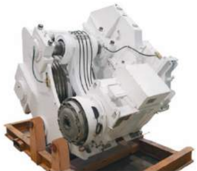
Transmisión reparada y reacondicionada (después)
